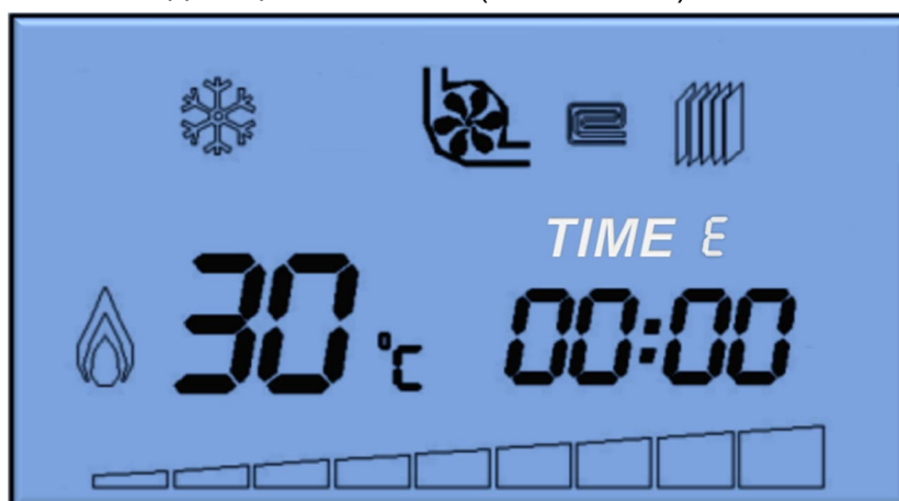
Рис 24. Индикация режима работы электродкотла по датчику уличной температуры.
