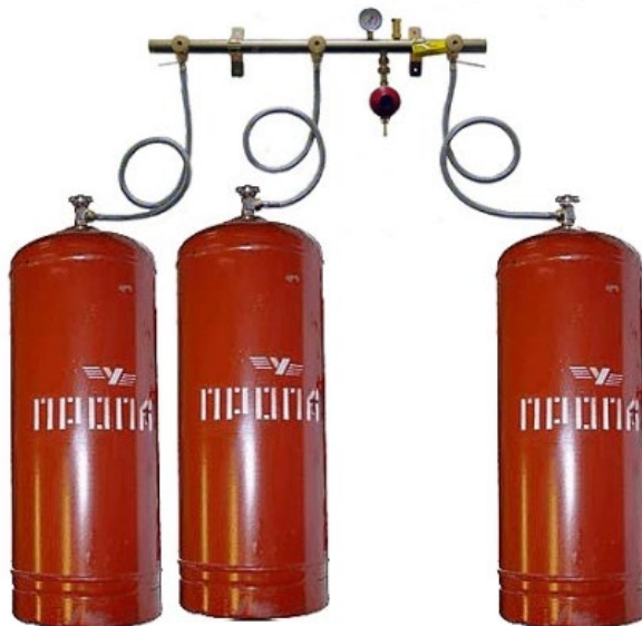
Рис. 18 Баллонная установка из трёх баллонов объёмом 50 л с коллектором и редуктором (регулятором давления газа)
