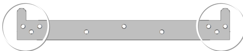
Рис. 9 Монтажная планка (кронштейн крепления котла на стене)
